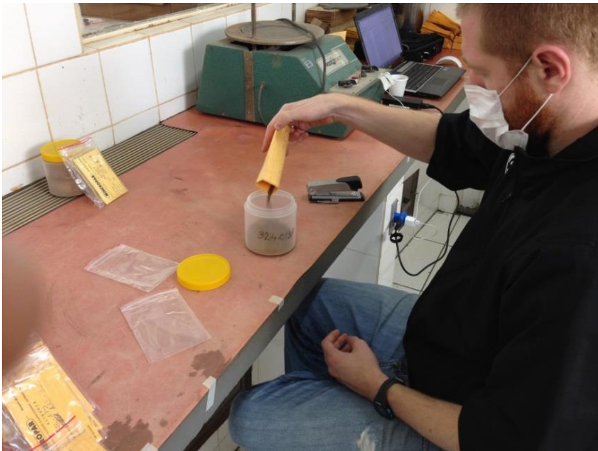
Figura 8: Preparação das amostras compostas no laboratório da MINEROPAR, no Bairro Tarumã, em Curitiba.
