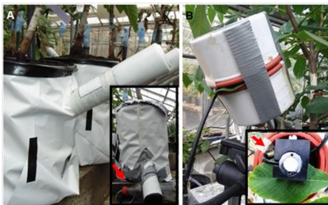
Figura 3.1 – (a) Vasos dispostos sobre as balanças eletrônicas e equipados com os tubos minirizotrons e tensiômetros, com detalhe para os reservatórios plásticos para a coleta de água lixiviada; e, (b) psicrômetros instalados nas folhas terminais, com detalhe para a cápsula de isolamento. Foto: Daniela Jerszurki
