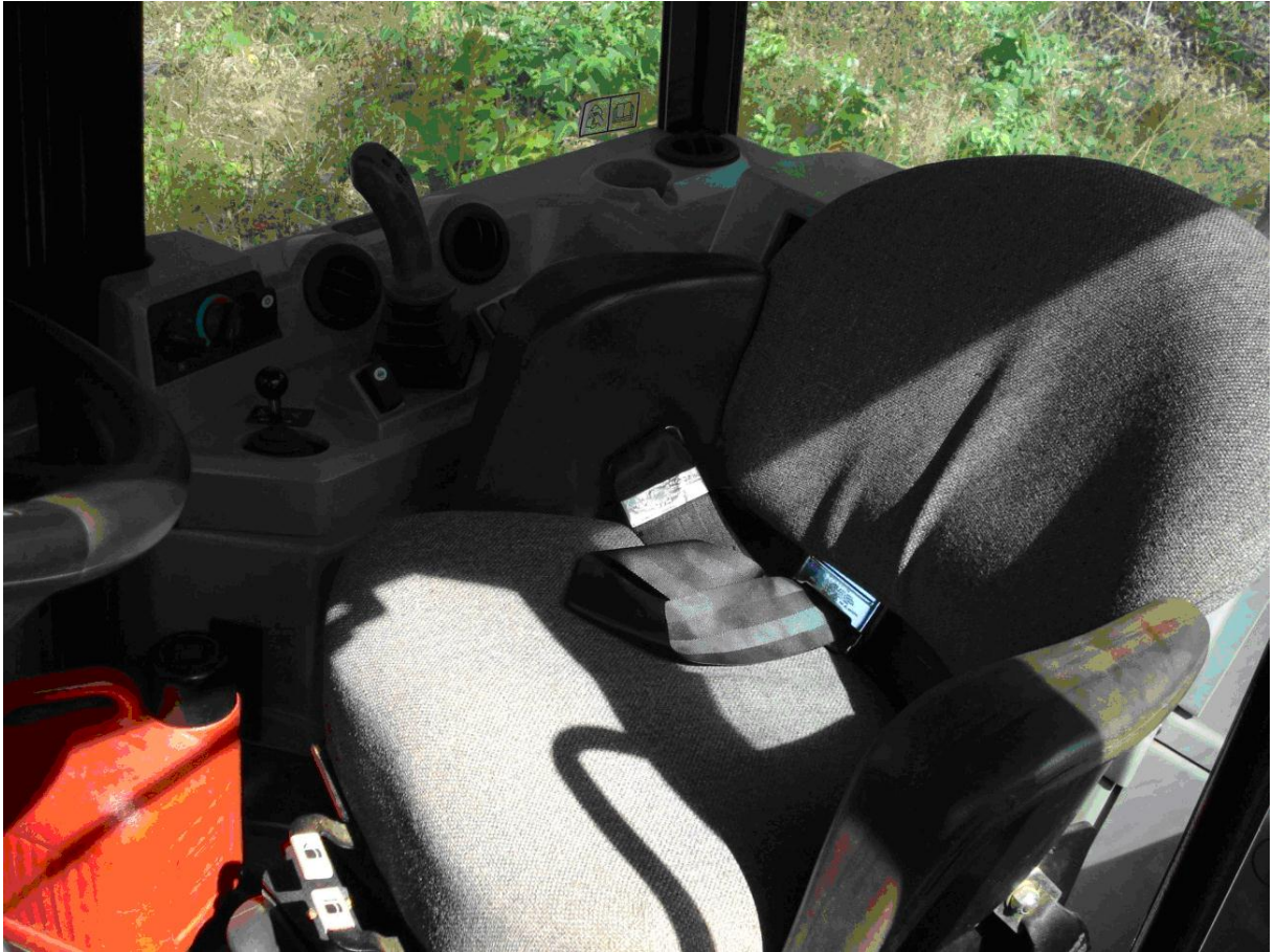
FIGURA 2: ASSENTO DO OPERADOR DO SKIDDER GIRADO 15° EM RELAÇÃO AO EIXO LONGITUDINAL DA MÁQUINA.
