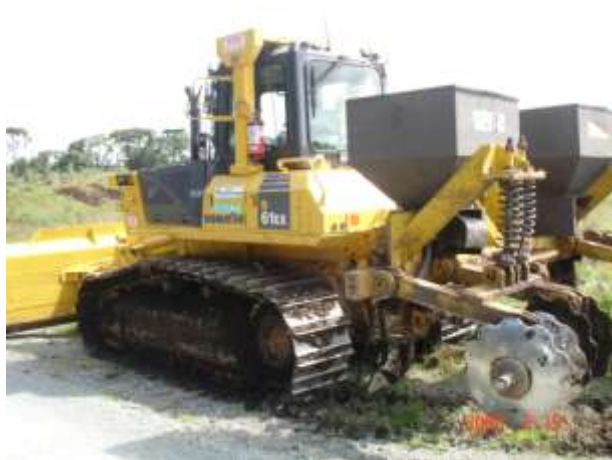
Figura 2. Subsolador com sistema controlado de distribuição de fosfato.
