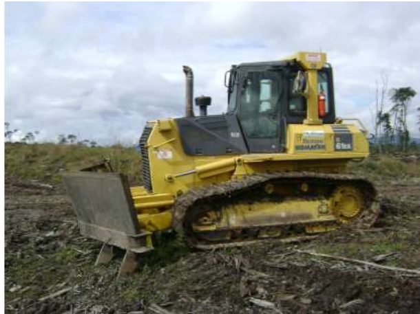
Figura 1. Implemento Limpa Trilho com sistema hidráulico.
