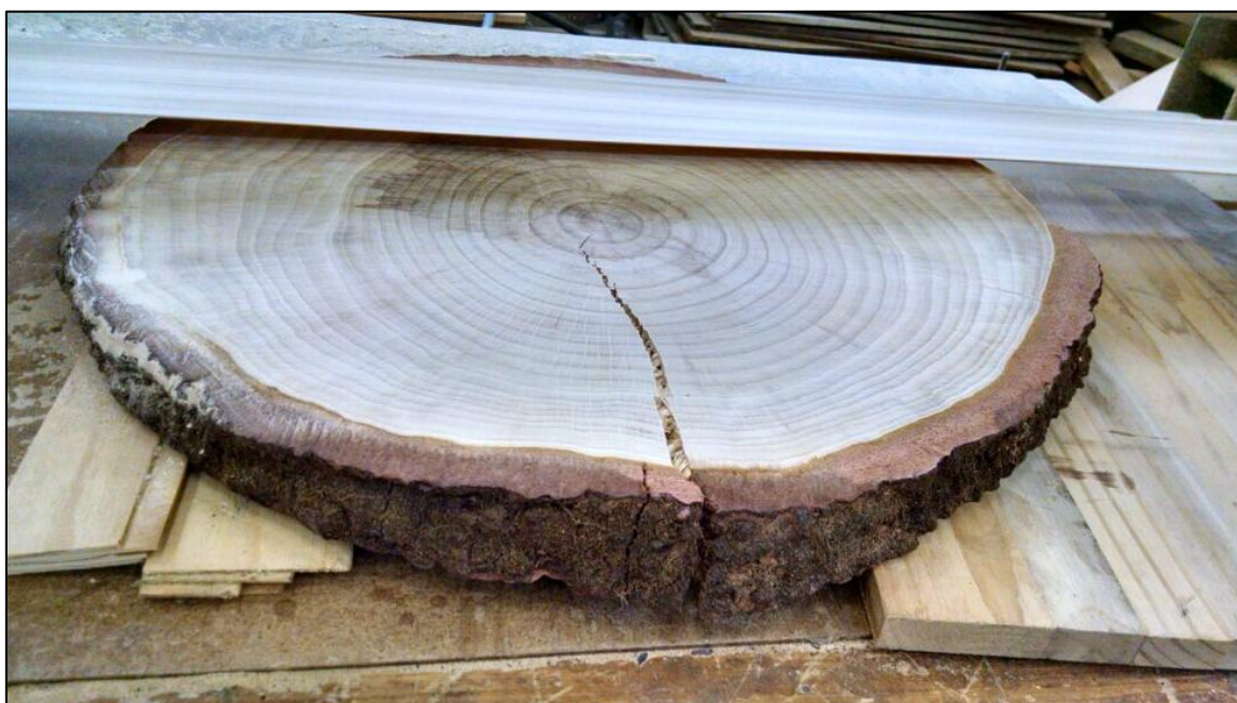
Figura 2. Fase de lixamento das seções transversais.
