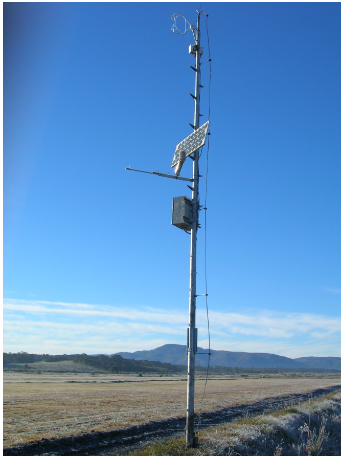
Figura 4.5: Estação de monitoramento de superfície.
