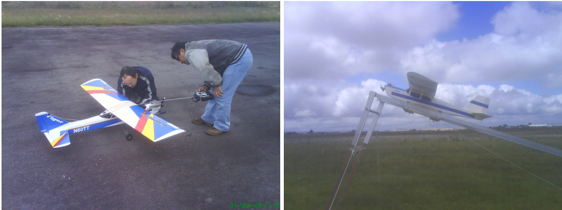
Figura 4.14: Outros aeromodelos utilizados para testes do piloto automático (a) e de catapulta (b).
