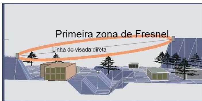
FIGURA 2.1 – REPRESENTAÇÃO DA PRIMEIRA ZONA DE FRESNEL
