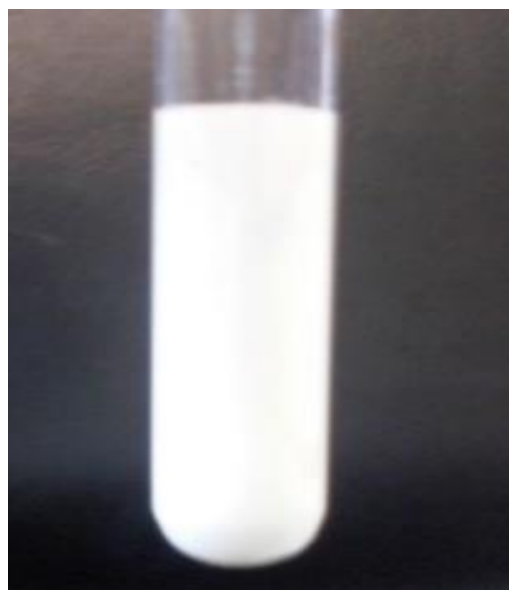
FIGURA 6 - EMULSÃO MÚLTIPLA A_1/O/A_2 NA AUSÊNCIA DO COMPONENTE ATIVO SULFATO DE GLUCOSAMINA (D)(2KCl) 20 DIAS APÓS O PREPARO, COM ASPECTO HOMOGÊNEO E SEM SEPARAÇÃO DE FASES
