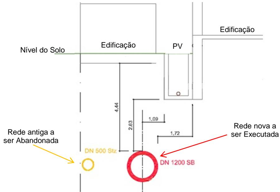
FIGURA 25 – PROJETO EM CORTE QUE APRESENTA A SUBSTITUIÇÃO POR UM NOVO TRAJETO, NO QUAL A REDE ANTIGA É ABANDONADA E A NOVA EXECUTADA EM OUTRO LOCAL
