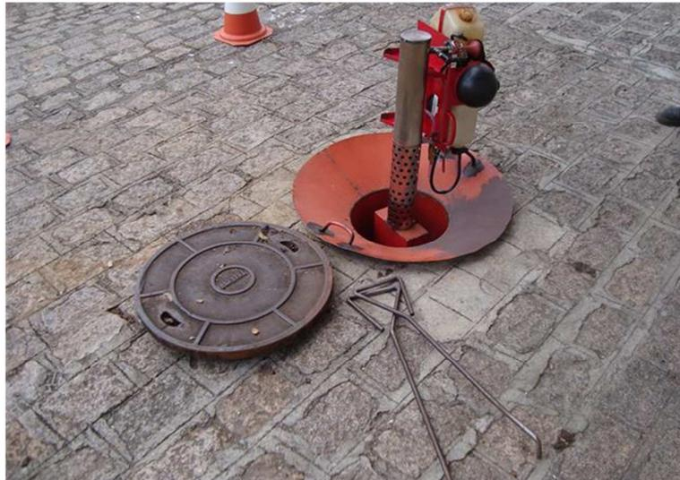
FIGURA 29 – EQUIPAMENTO TERMONEBULIZADOR PARA EXECUÇÃO DO TESTE DE FUMAÇA
