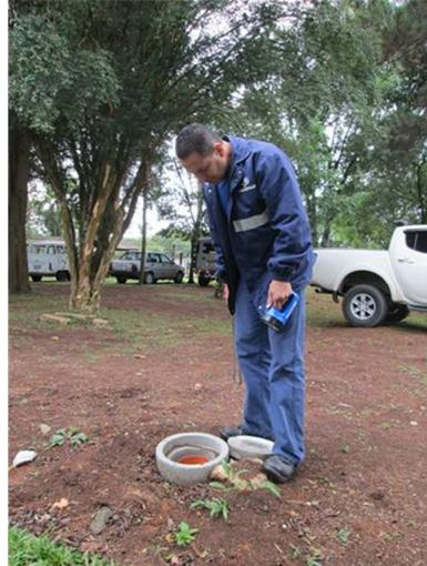
FIGURA 28 – FUNCIONÁRIO VERIFICANDO A PASSAGEM DO CORANTE PELO DTI
