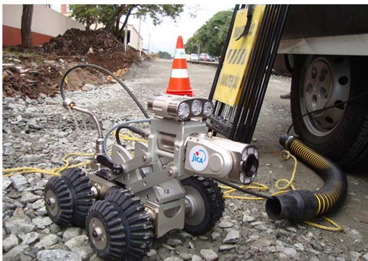
FIGURA 35 – CÂMERA ROBÔ FORNECIDO PELA JICA UTILIZADA NO TELEDIAGNÓSTICO
