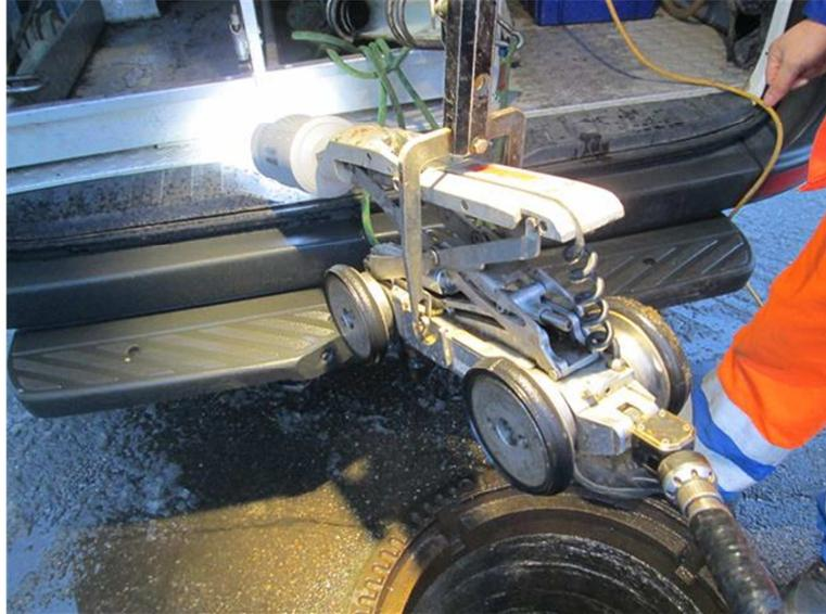
FIGURA 9 – CÂMERA ROBÔ UTILIZADO PARA INVESTIGAÇÃO DAS RCE EM STUTTGART
