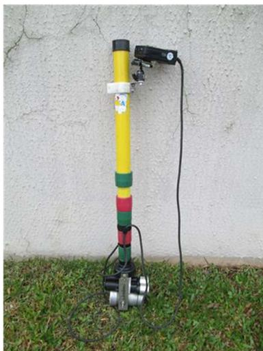
FIGURA 31 – CÂMERA DE INSPEÇÃO RÁPIDA DE PV PARA AVALIAÇÃO DE PV E RCE
