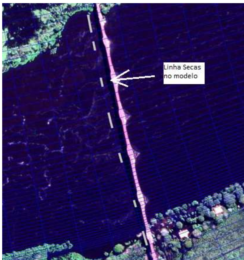
Figura 5.11 – Localização das linhas secas, que representam os pilares da ponte dentro do modelo, canal principal.
