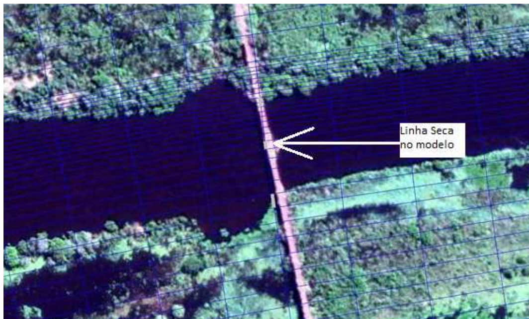
Figura 5.12 – Localização das linhas secas, que representam os pilares da ponte dentro do modelo, canal entre a ilha do Jacaré e a margem direita.
