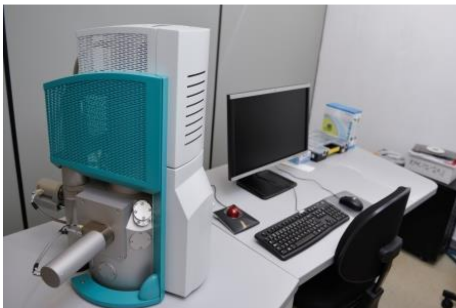
Figura 14. Microscópio eletrônico de varredura TESCAN VEGA3 LMU dentro do Centro de Microscopia Eletrônica da UFPR (CME-UFPR), utilizado para a análise morfológica dos biomateriais.
