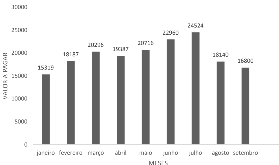
FIGURA 1: ALTERAÇÃO NA CONTA DE LUZ DO POSTO DE COMBUSTÍVEL APÓS INSTALAÇÃO DE LÂMPADAS LED REALIZADA NO MÊS DE AGOSTO FONTE: o Autor (2015)
