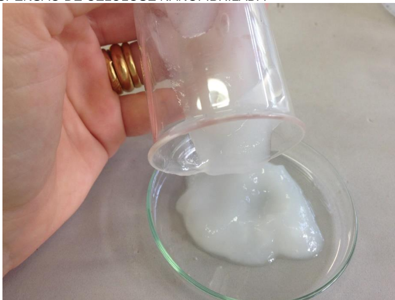
FIGURA 6 – SUSPENSÃO DE CELULOSE NANOFIBRILADA
