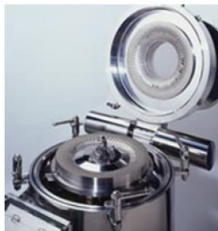
FIGURA 2 – MOINHO DE NANOCELULOSE SUPER MASSCOLLOIDER MASUKO SANGYO
