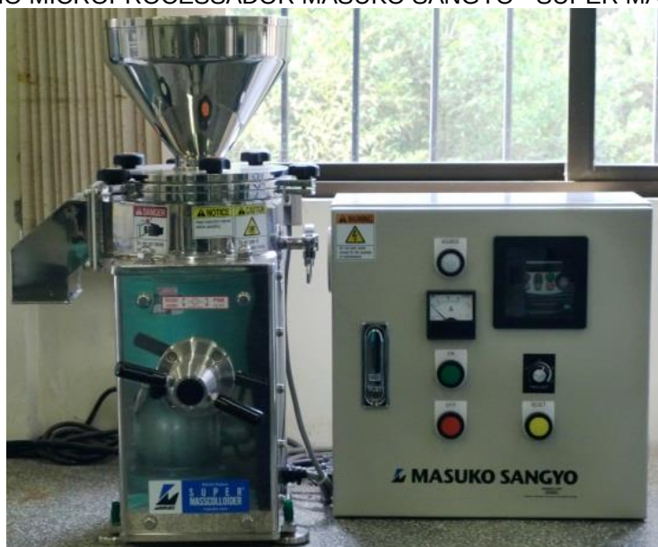
FIGURA 5 - MOINHO MICROPROCESSADOR MASUKO SANGYO - SUPER MASSCOLLOIDER
