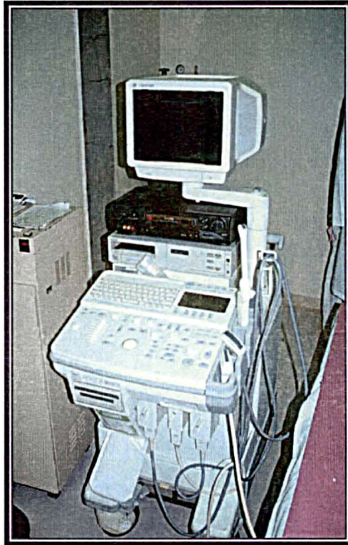
FIGURA 1 – APARELHO DE ULTRASSONOGRRAFIA DOPPLER COLORIDA, DA MARCA GE , MODELO LOGIQ 500 R , UTILIZADO NOS EXAMES DAS PACIENTES
