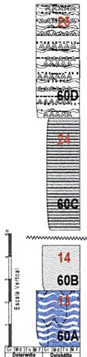
**Nível 25** - Dolarenito equigranular muito fino. Nível com 4,90 m. de espessura. Rocha de coloração cinza claro, maciça, granoblástica. O contato com o nível inferior é discordante. A rocha apresenta níveis de espessura decamétrica (20 cm) com esteiras algais. Estas, muitas vezes, apresentam um dobramento tectônico isoclinal aberto e localmente há a formação de estruturas sedimentares deposicionais “teepes”.
