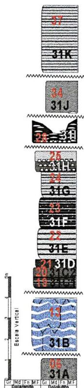
**Nível 37** - Dololuto grosso, intervalo com 3,5 m de espessura; continuidade lateral. Coloração cinza médio, granoblástica, equigranular com bandas cinza escura (3-5 cm) de espessura e foliação marcante.
