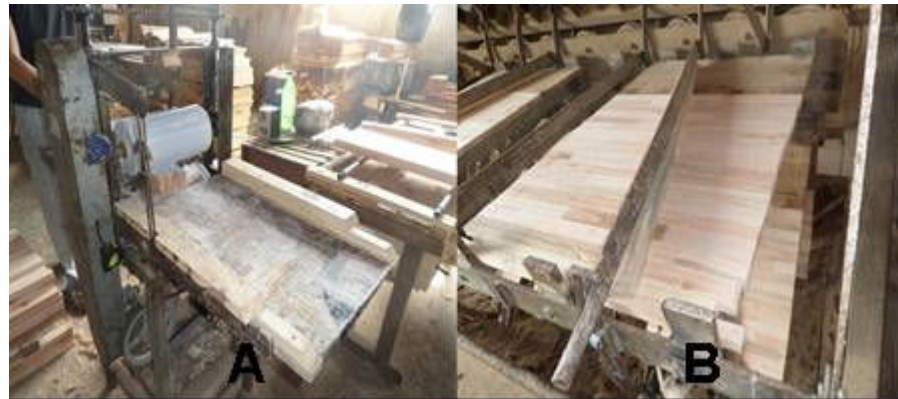
FIGURA 6. Colagem Lateral e Montagem dos painéis; A: Rolo aplicador de adesivo; B Prensagem lateral dos sarrafos.
