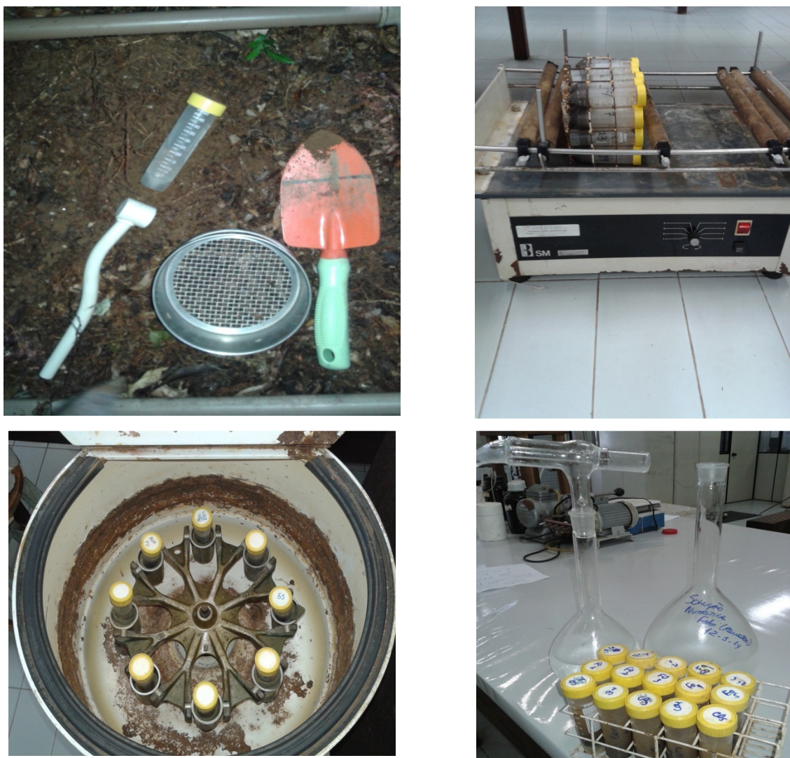
FIGURA 31. ILUSTRAÇÃO DA COLETA DO SOLO, AGITAÇÃO E CENTRIFUGAÇÃO DOS TUBOS CONTENDO A SOLUÇÃO EXTRATORA DE \text{KCl} 2 \text{ MOL L}^{-1} , E APÓS ADIÇÃO DA SOLUÇÃO NUTRITIVA PARA O ENSAIO DE MINERALIZAÇÃO ANAERÓBICA EM LABORATÓRIO. FONTE: O AUTOR.
