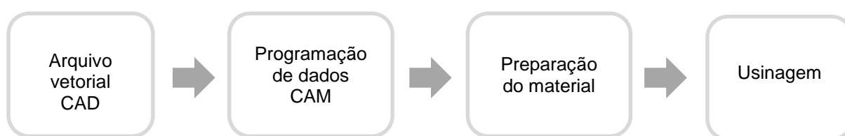
FIGURA 4 – FLUXO DE OPERAÇÕES DO SISTEMA CAD/CAM. FONTE: A autora (2015).
