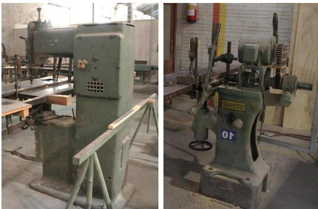
FIGURA 38 – FURADEIRA VERTICAL E FURADEIRA HORIZONTAL ORIGINAIS DA MÓVEIS CIMO S.A. – VILA NOVA, RIO NEGRINHO – SC. FONTE: A autora (2015).
