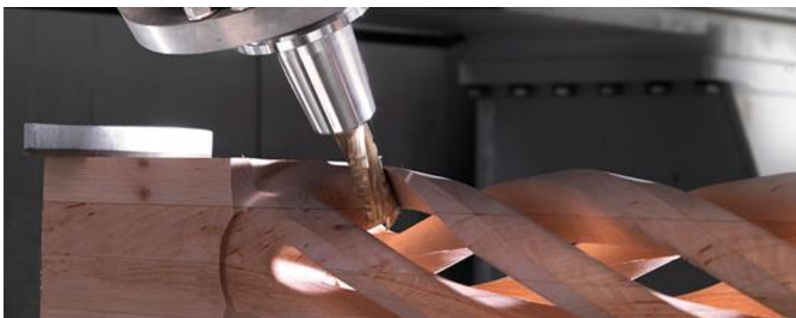
FIGURA 5 – USINAGEM NA MADEIRA - CNC ROVER B. FONTE: Site da empresa na internet 5 (2015).
