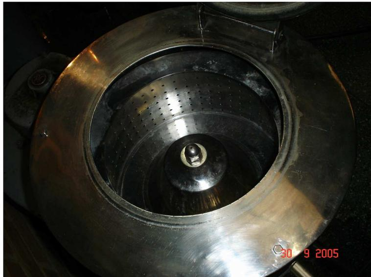
FIGURA 2 – CENTRÍFUGA INDUSTRIAL UTILIZADA DURANTE O PROCESSAMENTO DA ABÓBORA.
