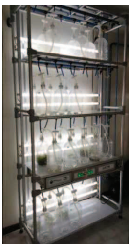
Figura 2. Modelo do Biorreator de Imersão Temporária patenteado pela Embrapa Recursos Genéticos e Biotecnologia utilizado nos experimentos de multiplicação em biorreator.
