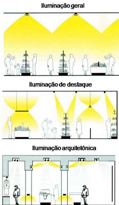
Figura 13 Tipos de iluminação Fonte: Manual de iluminação comercial Phillips
