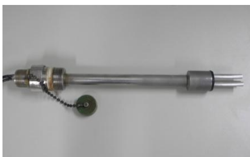
Figura 25: Sonda de corrosão: eletrodos na extremidade direita e rosco para fixação ao reator na extremidade esquerda.
