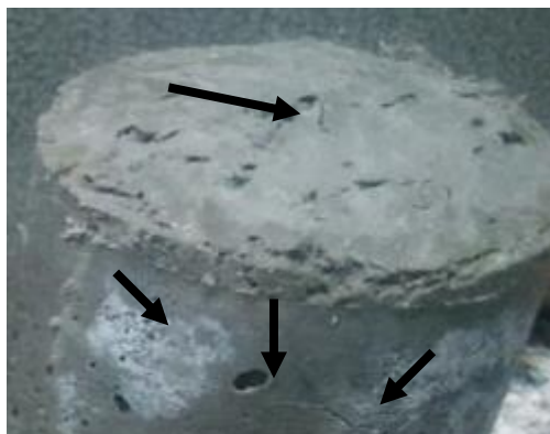
Figura 4.9 - Aspecto do topo do corpo de prova curado em autoclave, método 1 Fonte: Autoria própria (2015)
