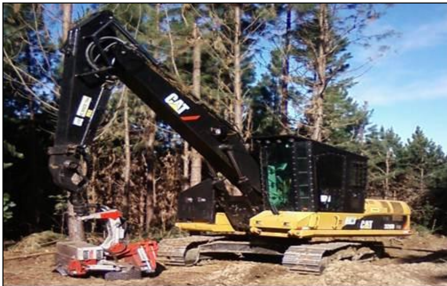
FIGURA 3 – ESCAVADEIRA FLORESTAL CAT 320D FM E CABEÇOTE LOG MAX 6000B.
