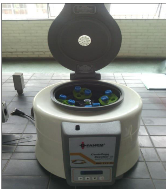
FIGURA 10 – Preparação da centrifugação das amostras bifásicas do Método de Hartman-Lago
