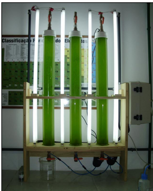
FIGURA 4A – Fotobiorreator tubular do tipo coluna de bolhas desenvolvido por GRESSLER (2011) FONTE: BJERK, 2012
