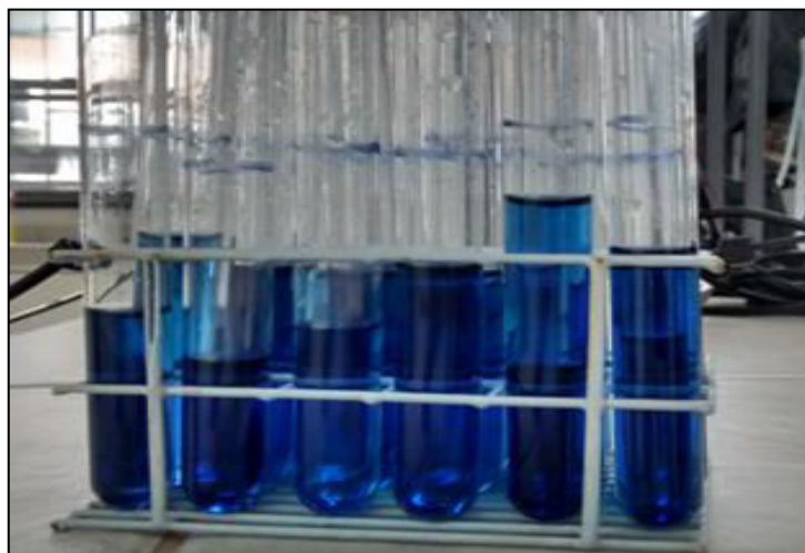
FIGURA 11 – A cor azul característica da solução de complexo ácido fosfomolibdato
