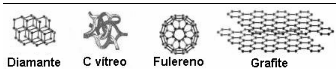
Figura 10: Algumas formas alotrópicas do carbono.
