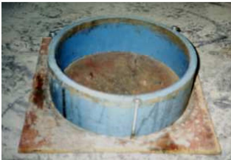
FIGURA 19. FORMA PARA A MOLDAGEM DOS CPS PARA ENSAIO DE ABRASÃO
