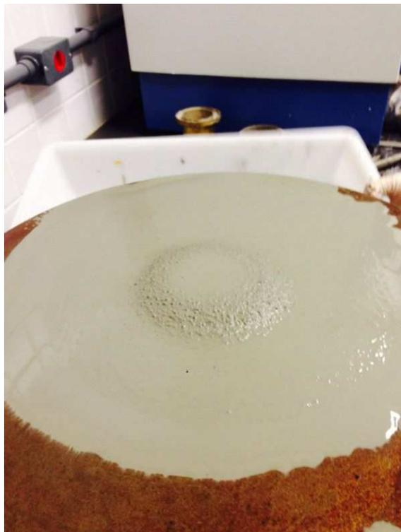
FIGURA 24. ENSAIO FLOW TABLE COM O MATERIAL SEGREGADO
