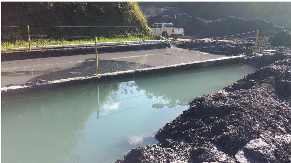
FIGURA 2. BACIA DE DECANTAÇÃO DE MATERIAL PULVERULENTO NA PRODUÇÃO DE AREIA ARTIFICIAL
