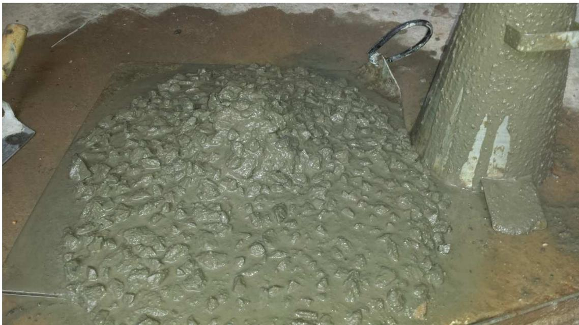
FIGURA 8. CONCRETO COM LEVE SEGREGAÇÃO
