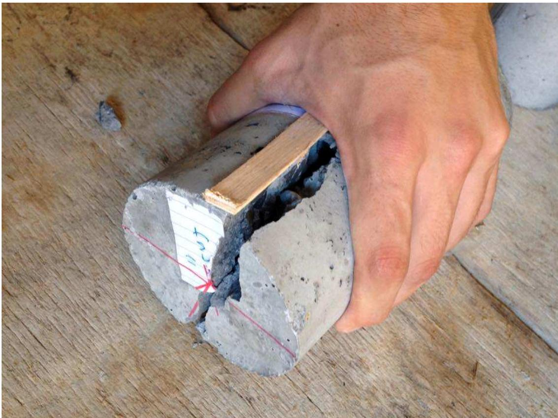
FIGURA 21. CP ROMPIDO DURANTE ENSAIO DE COMPRESSÃO DIAMETRAL
