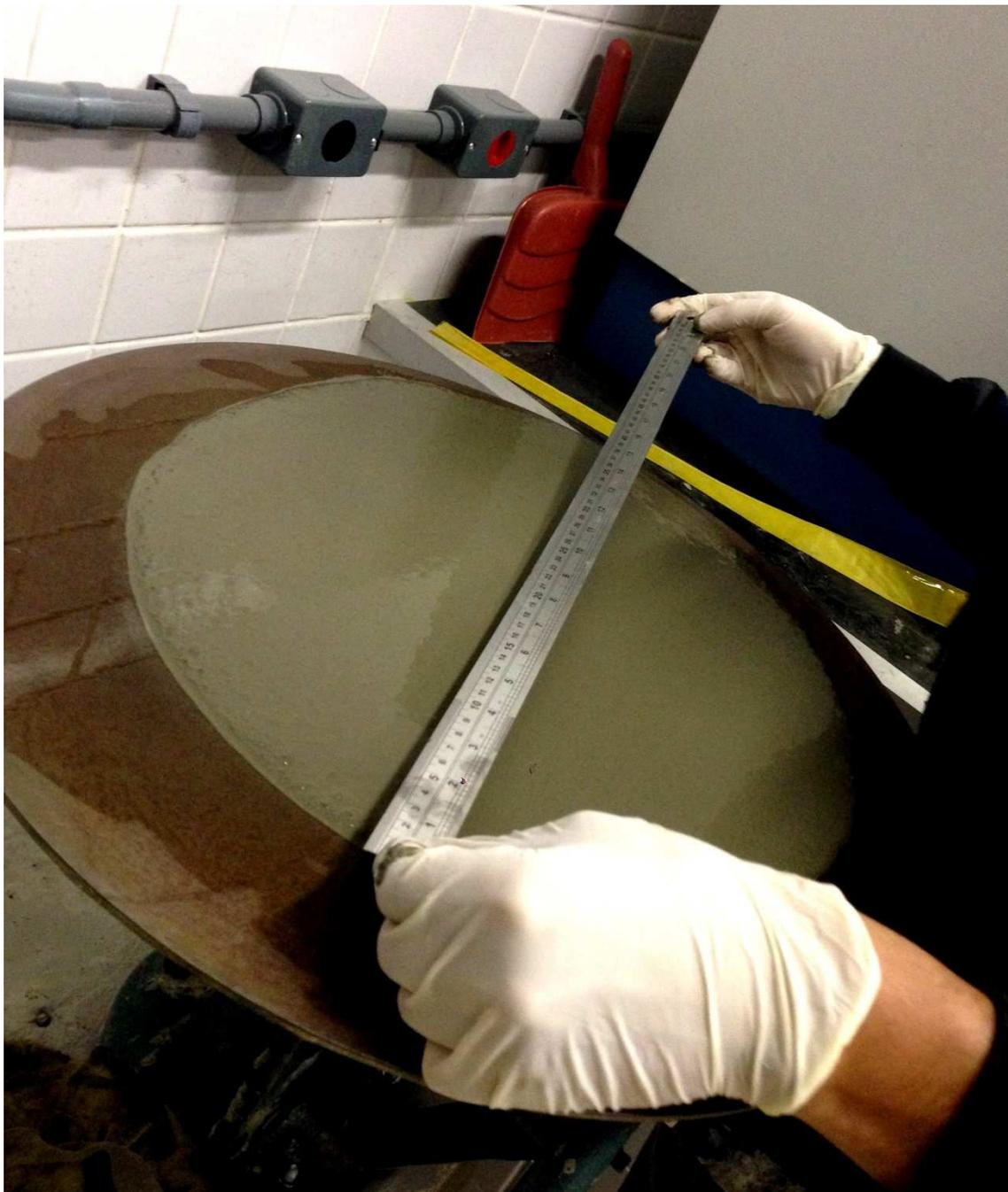
FIGURA 17. EXECUÇÃO DO ENSAIO FLOW TABLE
