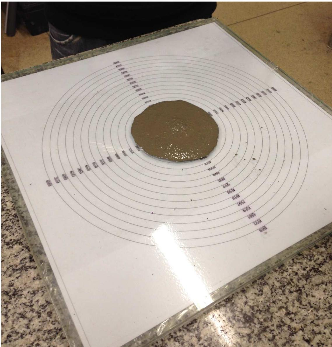
FIGURA 18. EXECUÇÃO DO ENSAIO DE CONE DE KANTRO
