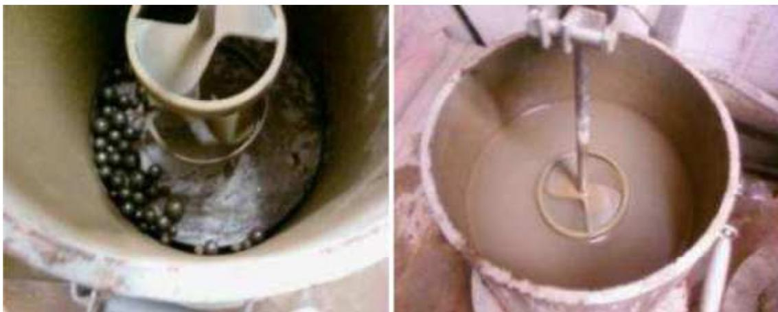
FIGURA 20. EQUIPAMENTO PARA ENSAIO À ABRASÃO DO CONCRETO
