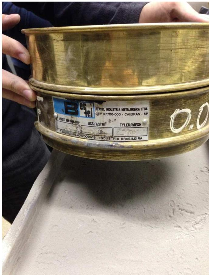
FIGURA 13. MATERIAL PULVERULENTO DURANTE PROCESSO DE PENEIRAMENTO
