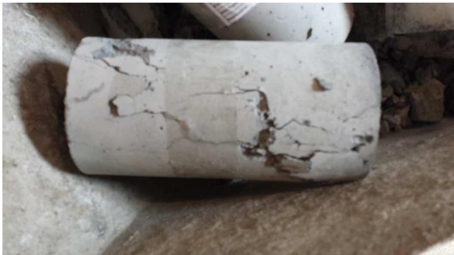
FIGURA 27. CP ROMPIDO COM COMPRESSÃO SIMPLES
