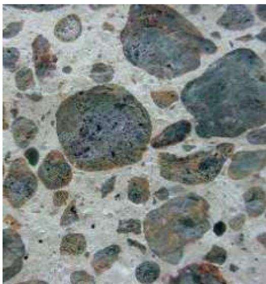
FIGURA 4. ESTRUTURA MACROSCÓPICA DO CONCRETO – AGREGADOS E PASTA
