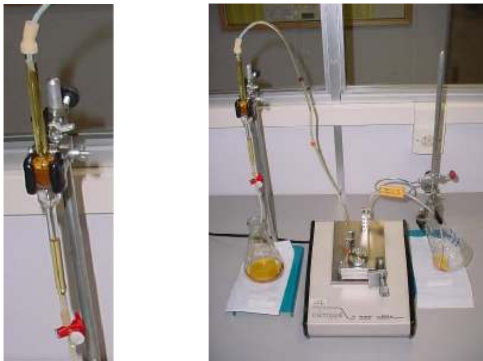
Figura 22 - Sistema utilizado para a avaliação do desempenho das resinas P-SO 2 NH 2 em laboratório.
