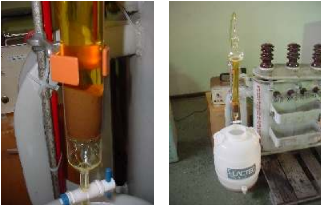
Figura 29 - Sistema utilizado para a regeneração de OMI envelhecido, em grande escala, utilizando as resinas P-SO 2 NH 2 .
