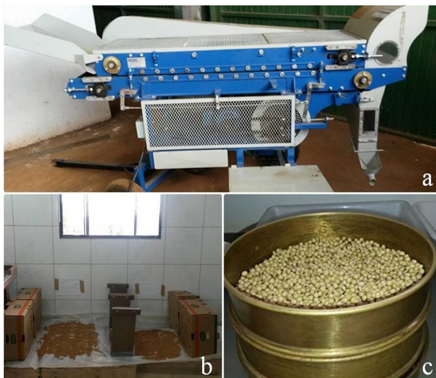
FIGURA 5. Unidade de beneficiamento da Empresa KSP sementes: Trilhadora (a). Secagem das sementes sob condições naturais: local coberto e ventilado com as sementes distribuídas em lonas sobre pallet (b). Peneiras para limpeza das sementes (c).
