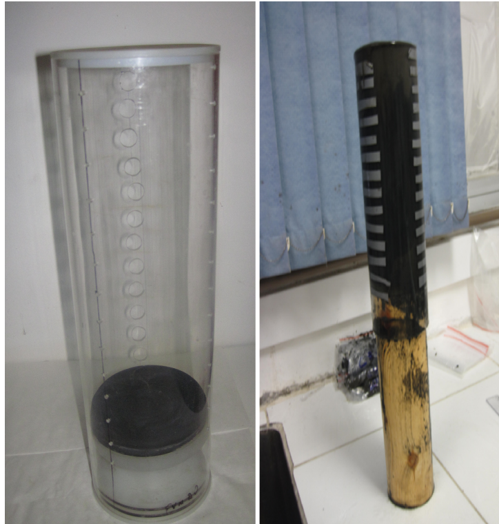
Figura 4: Tubos preparados com orifícios específicos para a coleta da água intersticial a entrada dos eletrodos/Utilização do êmbolo para extrusão do sedimento
