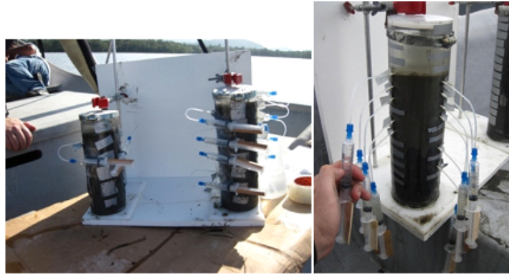
Figura 5: Sistema de coleta da água Intersticial (AI) através do sistema Rizoma
