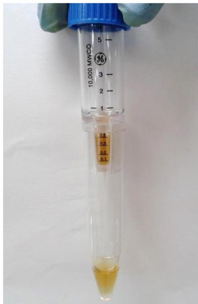
FIGURA 55 – MEMBRANA VIVASPIN (GE HEALTHCARE®) DE 10.000 MWCO CONTENDO FRAÇÕES DE RETIDO E PERMEADO.
