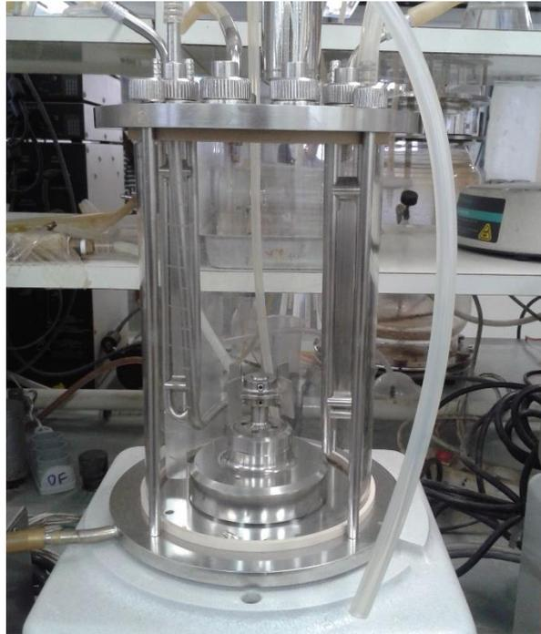
FIGURA 17 - BIORREATOR DO TIPO TANQUE AGITADO INCELTECH Set 2M (LH, SGi).
