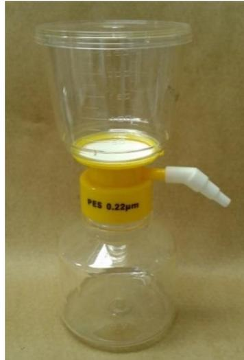
FIGURA 18 – SISTEMA DE FILTRAÇÃO À VÁCUO PES 0,22  $\mu\text{m}$  (KASVI®).
