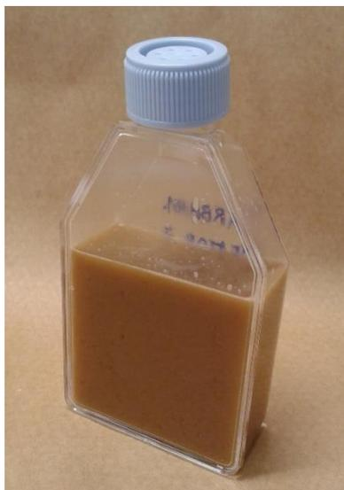
FIGURA 56 – MEIO FERMENTADO A PARTIR DE VINHAÇA DE SOJA EM BIORREATOR.
