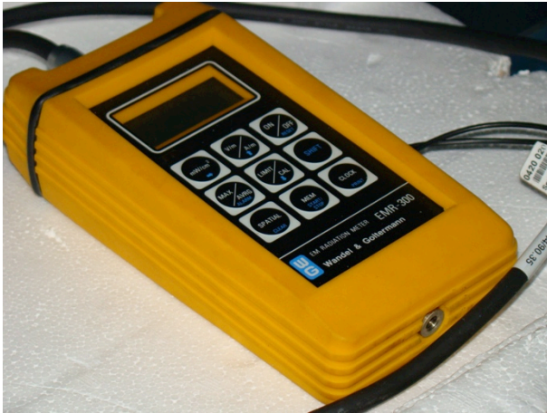
Figura 74: sensor EMR-300 WG Fonte: autor (2014)
