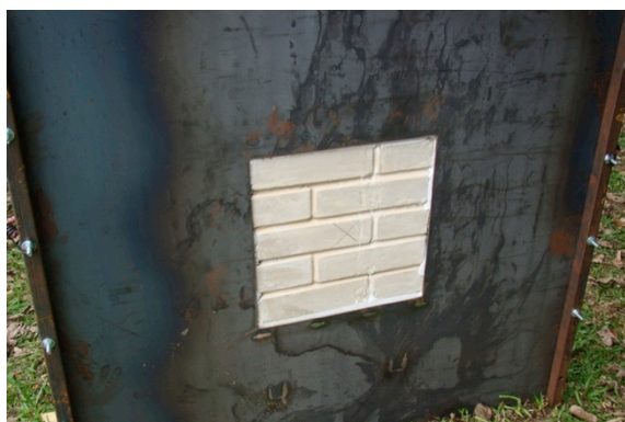
Figura 139: medição final CF-4000 Alvenaria de blocos de solo-cimento
