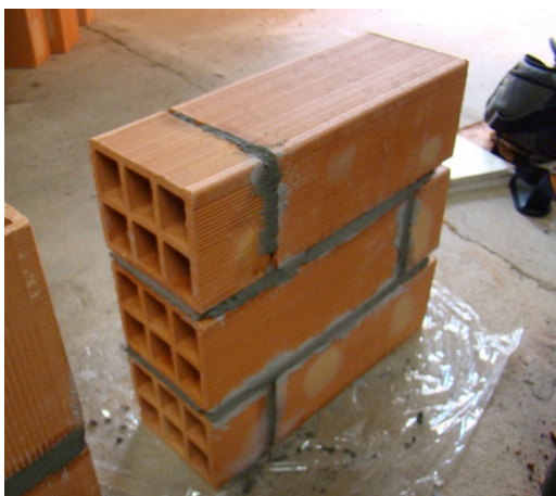
Figura 65: prisma de bloco cerâmico não estrutural
