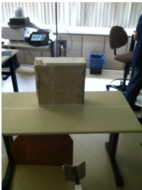
Figura 110: medição amostra alvenaria de solo-cimento
