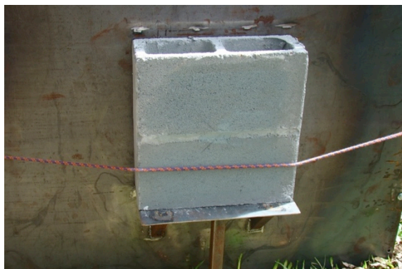
Figura 137: medição final CF-4000 Alvenaria de blocos de concreto Fonte: autor (2015)
