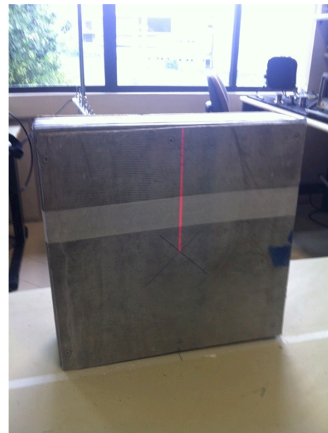
Figura 105: medição amostra alvenaria Light Steel Framing
