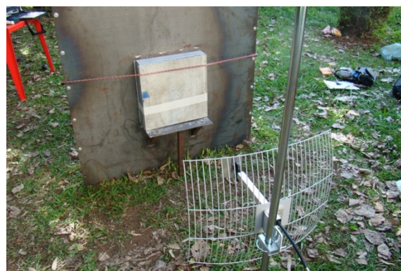
Figura 132: medição final MM-2420 Light Steel Framing
