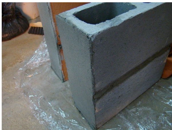
Figura 67: prisma de bloco de concreto
