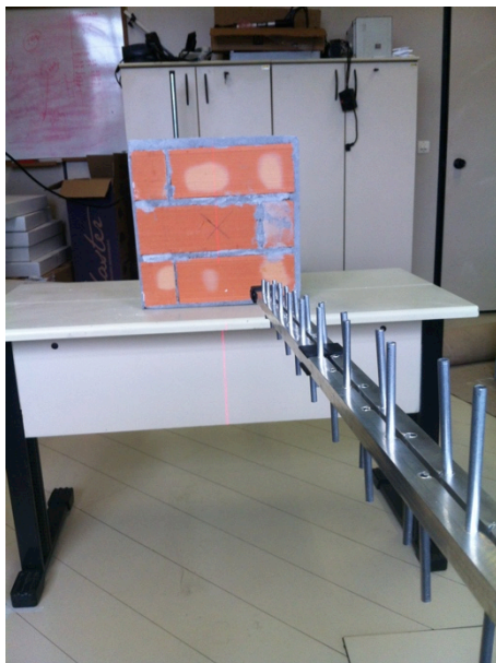
Figura 104: medição amostra alvenaria cerâmica não estrutural
