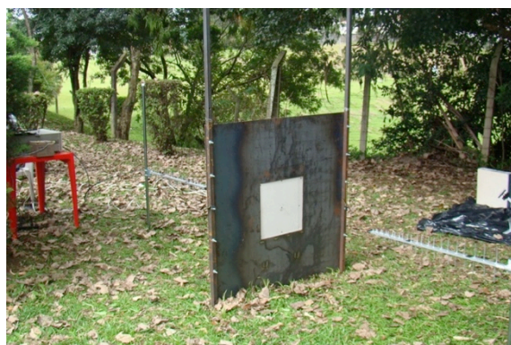
Figura 131: medição final CF-4000 Light Steel Framing
