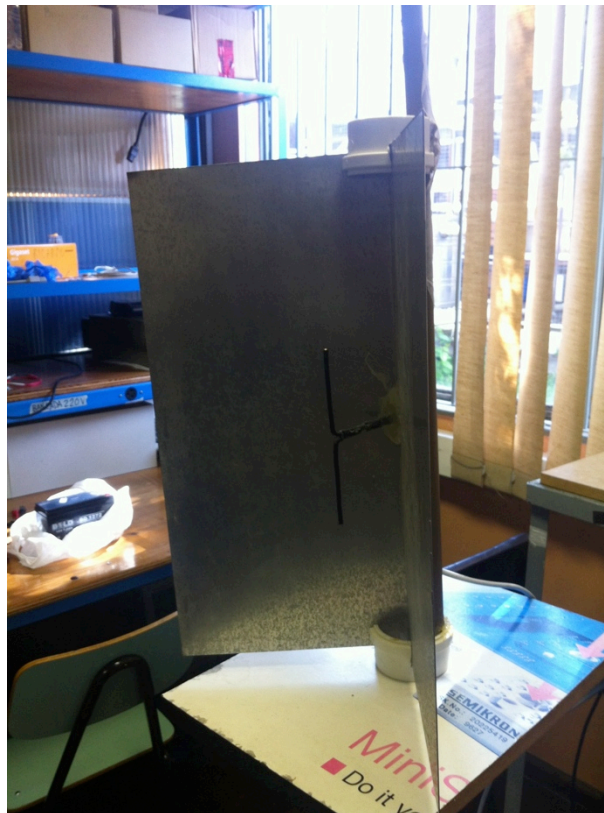
Figura 90: sistema composto de uma antena dipolo e diedro em chapa metálica Fonte: autor (2014)
