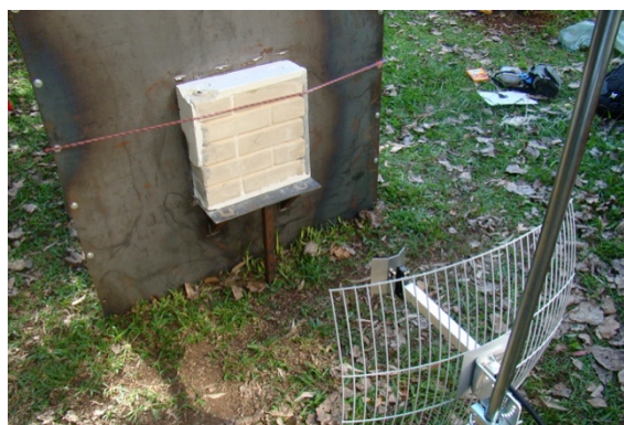
Figura 140: medição final MM-2420 Alvenaria de blocos de solo-cimento
