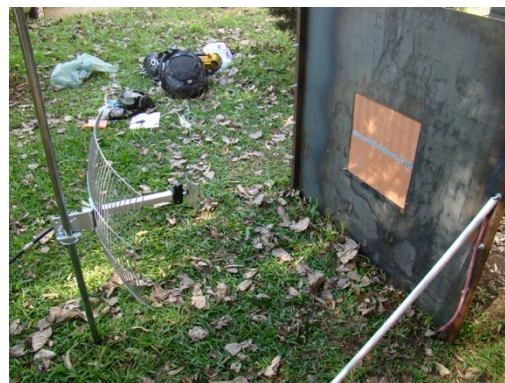
Figura 136: medição final CF-4000 Alvenaria de blocos cerâmicos estruturais
