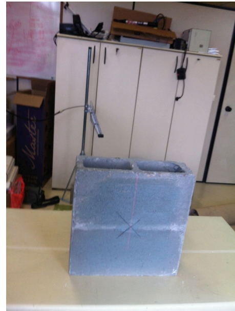
Figura 103: medição amostra alvenaria de concreto
