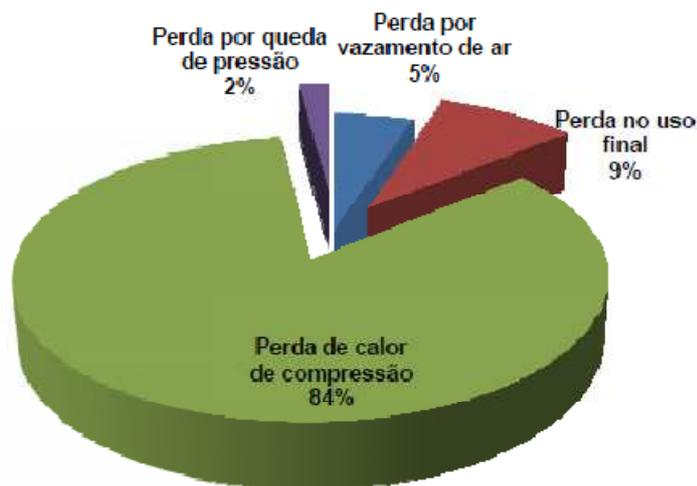
FIGURA 5 – DIAGRAMA DE PERDAS CARACTERÍSTICAS DE SISTEMAS DE AR COMPRIMIDO
