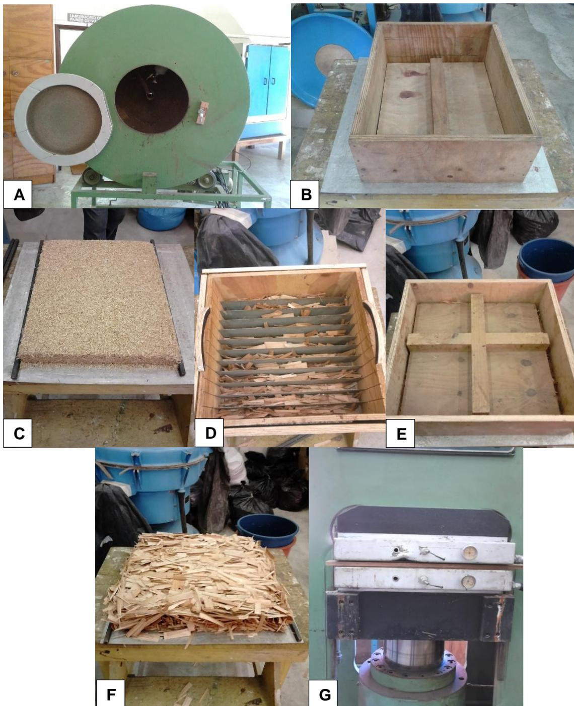
FIGURA 10 – PROCESSO DE PRODUÇÃO DOS PAINÉIS.
