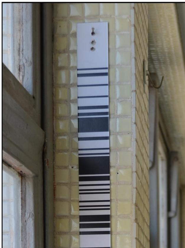
FIGURA 43- FUROS NA MIRA ALVO PARA POSSIBILITAR A SIMULAÇÃO DE RECALQUE
