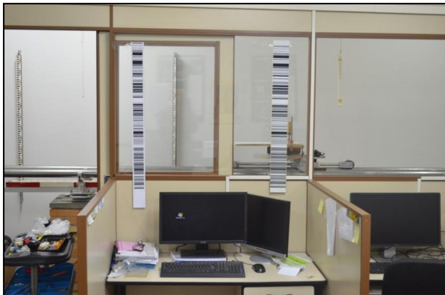
FIGURA 47- TESTE DE LEITURA EM AMBIENTES COM POUCA ILUMINAÇÃO (DEPENDÊNCIAS DO LAIG)
