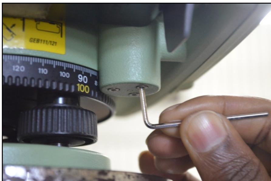
FIGURA 25- USO DA CHAVE ALLE NOS PARAFUSOS DE RETIFICAÇÃO
