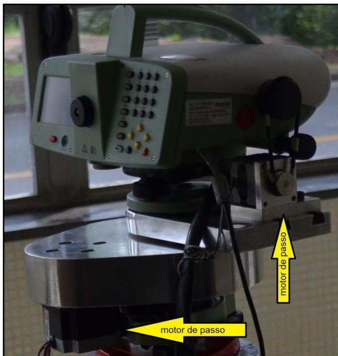
FIGURA 32- MOTORES DE PASSO ACOPLADOS NO DAMP
