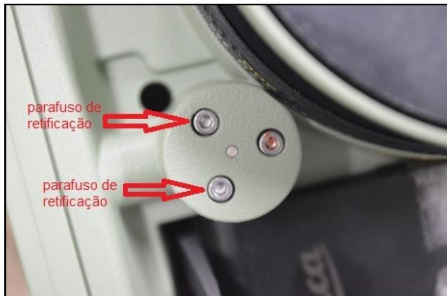
FIGURA 24- PARAFUSOS DE RETIFICAÇÃO
