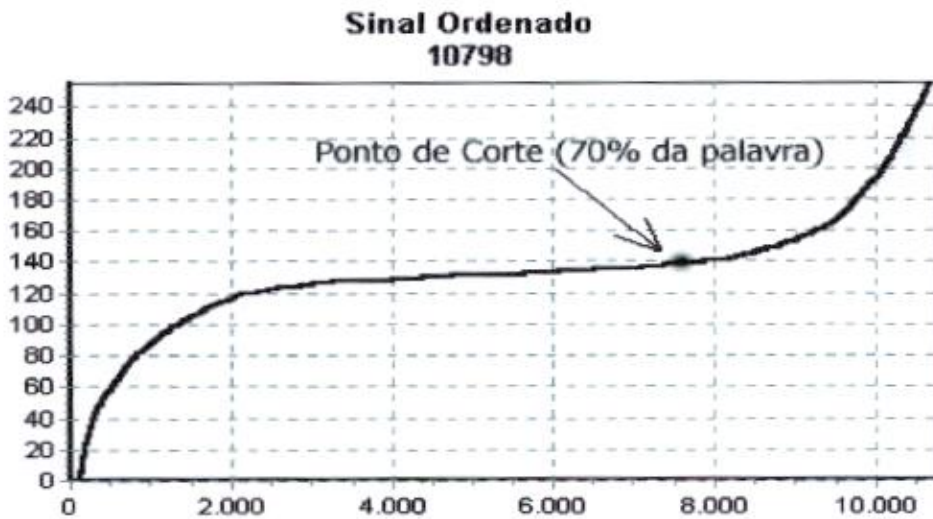
Figura 5.3.2 Mostra o ponto de corte, onde acima dele todos os valores passam a ser 1 e abaixo passam a ser 0.
