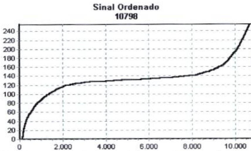
Figura 5.3.1 Mostra o gráfico do mesmo sinal capturado, agora ordenado pelas suas amplitudes.
