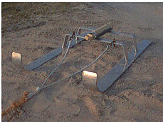
FIGURA 5: SISTEMA DE TRENÓ EQUIPADO COM STD SD 200. POSSUI COMO DIMENSÕES NOMINAIS 120 CM DE COMPRIMENTO POR 75 CM DE LARGURA.
