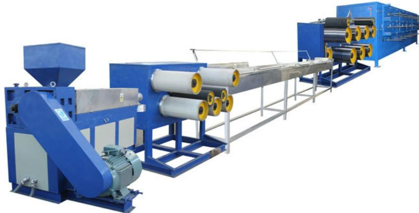
FIGURA 20 - Máquina de extrusão de chapas plásticas.
