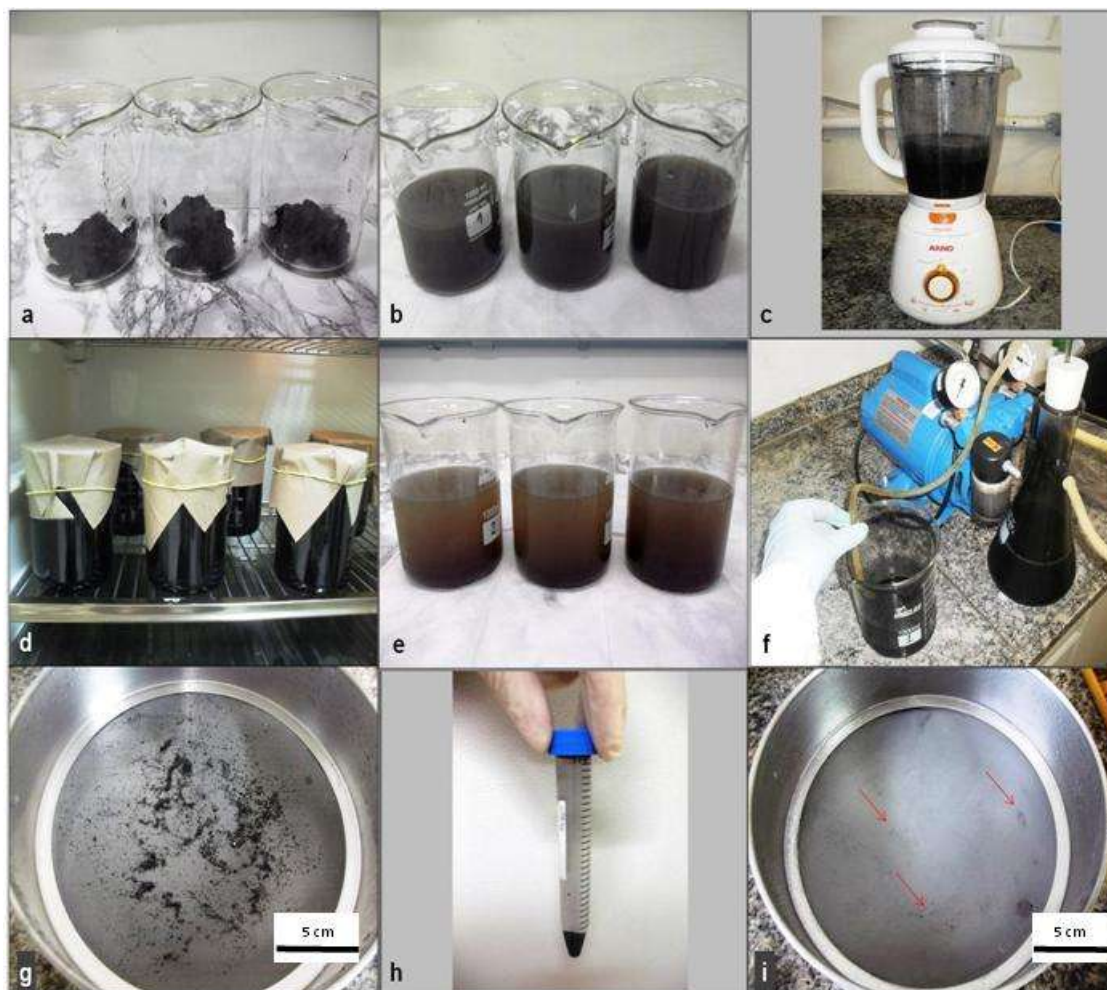
FIGURA 3.3 - PRINCIPAIS ETAPAS DA METODOLOGIA USEPA (2003) PARA QUANTIFICAÇÃO DE OVOS VIÁVEIS DE Ascaris EM LODO: a) 100 g DE AMOSTRA, EM TRIPLICATA, PARA ADIÇÃO DE INÓCULO; b) AMOSTRAS IMERSAS EM ÁGUA DEIONIZADA (14-16 HORAS); c) ROMPIMENTO DE GRÂNULOS POR LIQUIDIFICAÇÃO; d) ETAPA DE SEDIMENTAÇÃO A 4°C, COM DETERGENTE 7X; e) AMOSTRAS SEDIMENTADAS (SÓLIDOS DE FUNDO); f) REMOÇÃO DO SOBRENADANTE POR ASPIRAÇÃO A VÁCUO; g) PENEIRAMENTO 50 mesh (0,3 mm) COM RECUPERAÇÃO DO FILTRADO; h) AMOSTRA CENTRIFUGADA COM SULFATO DE MAGNÉSIO ( d= 1.2 \text{ g/mL} ) (RECUPERAÇÃO DO SOBRENADANTE); i) PENEIRAMENTO 400 mesh (0,04 mm) COM RECUPERAÇÃO DO RETIDO (SETAS). APÓS ESTA ETAPA, OS SEDIMENTOS RECUPERADOS SÃO INCUBADOS EM SOLUÇÃO \text{H}_2\text{SO}_4 0,1N, A 28 °C, POR 21 DIAS
