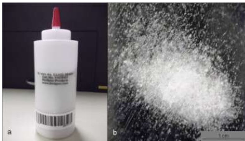
FIGURA 3.5 – MICROPÉROLAS DE VIDRO PARA LISE MECÂNICA DE CÉLULAS DE A. suum : a) FRASCO DE 500 g COMERCIALIZADO (BIOSPEC); b) MICROPÉROLAS DE VIDRO (0,1 mm DE DIÂMETRO)
