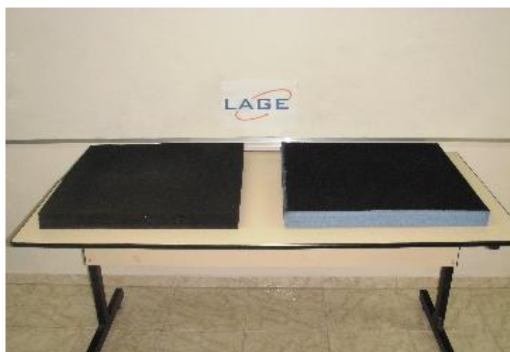
FIGURA 12- VISTA EM PERSPECTIVA DOS MATERIAIS ISOLANTES AEM-LAGE À ESQUERDA E O MATERIAL IMPORTADO C-RAM FONTE: VISKI (2010)
