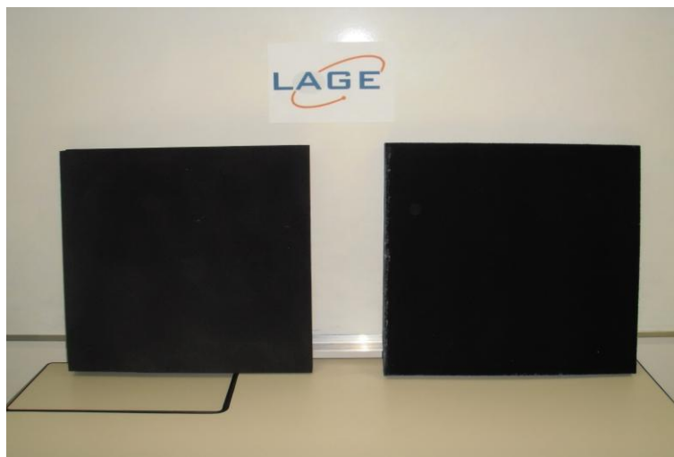
FIGURA 11- VISTA DE TOPO DOS MATERIAIS ISOLANTES AEM-LAGE À ESQUERDA E O MATERIAL IMPORTADO C-RAM FONTE: VISKI (2010)
