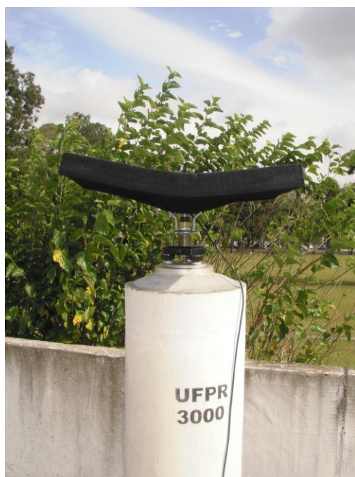
FIGURA 35- AEM-LAGEH 02 ELEVADO A 12 GRAUS FONTE: O autor (2012)
