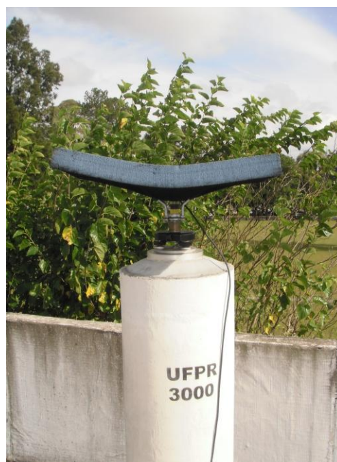
FIGURA 36- C-RAM ELEVADO A 12 GRAUS FONTE: O autor (2012)
