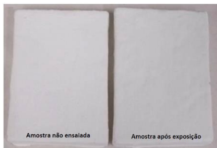
Figura 67 – CP3 após 600 horas no equipamento
