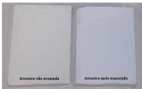
Figura 61 – CP1 após 600 horas no equipamento
