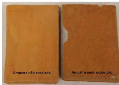
Figura 64 – CP2 após 600 horas no equipamento
