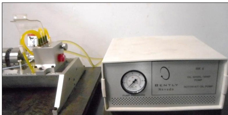
Figura 35 – Bomba de lubrificação forçada do mancal hidrodinâmico.
