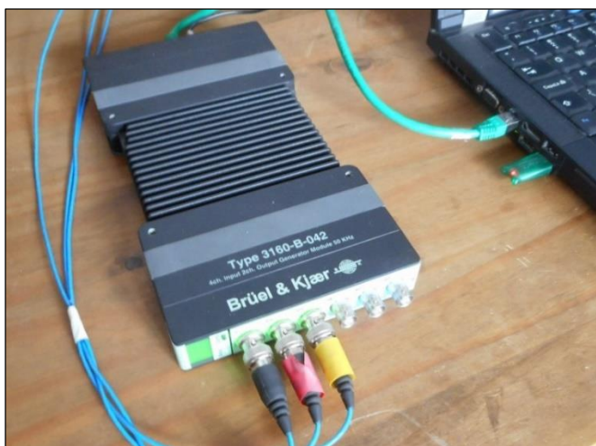
Figura D.2 – Placa de aquisição utilizada para medição das respostas ao desbalanceamento.
