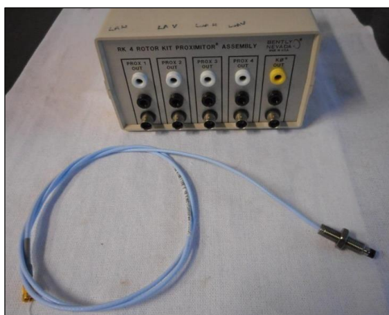
Figura D.1 – Conjunto de demoduladores e modelo de sensor de proximidade utilizados.
