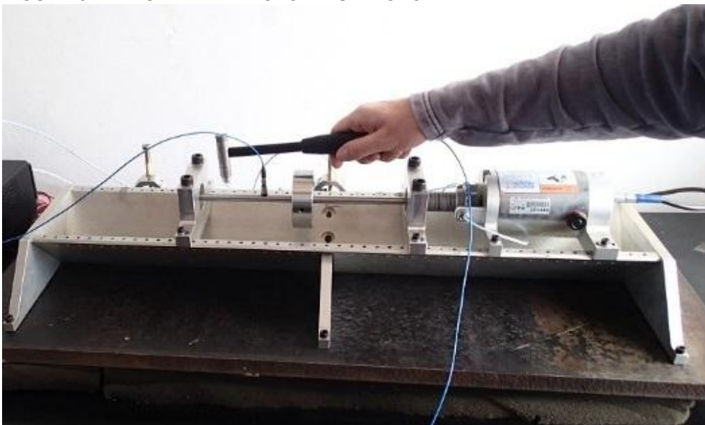
FIGURA 6.4 - TESTE DE IMPACTO DE UM ROTOR.
