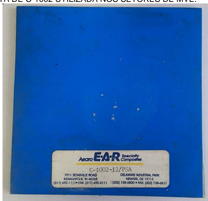
FIGURA 6.37 - MANTA DE C-1002 UTILIZADA NOS SETORES DE MVE.
