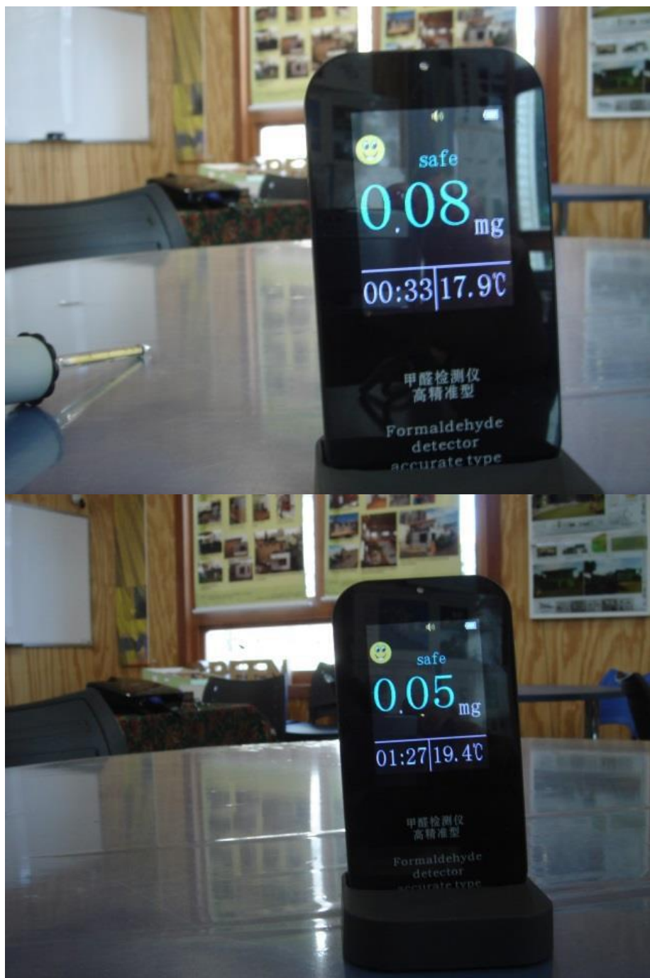
Figura 16 - Valor obtido pelo detector eletroquímico de formaldeído antes e depois da ventilação do Escritório Verde.
