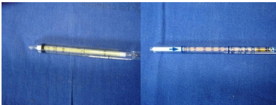
Figura 18 - Tubos colorimétricos MSA AUER e RAE Systems após a medida em laboratório de anatomia patológica: sem alteração da cor.
