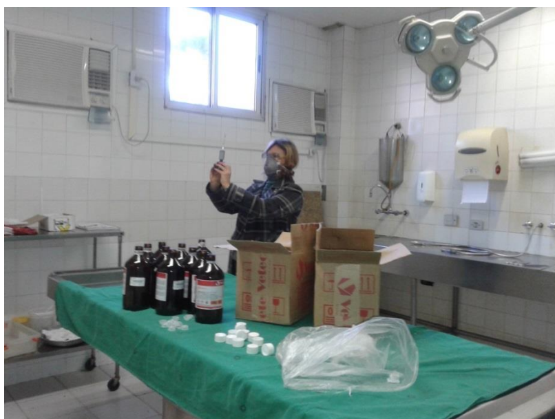
Figura 13 – Detecção da concentração de formaldeído em laboratório de Anatomia Patológica durante a diluição de 12 litros de formaldeído em 114 litros de água.
