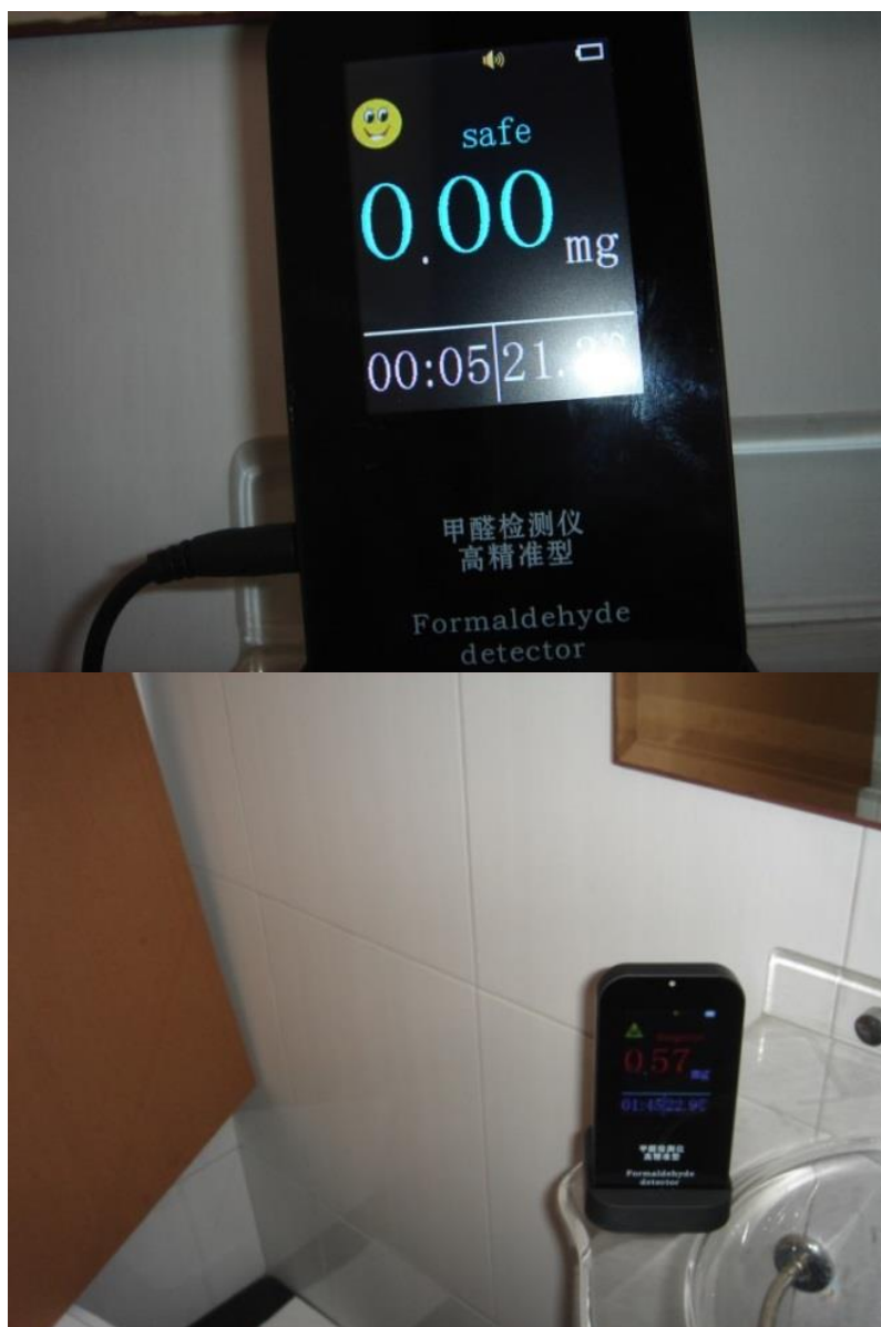
Figura 24 – Medida do ar com a janela e porta fechadas, antes da colocação do painel e após 2h.
