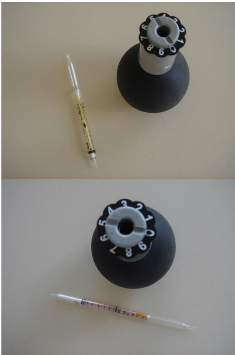
Figura 23 - Tubos colorimétricos MSA AUER e RAE Systems após a medida na sala administrativa do SCIH: sem alteração da cor.
