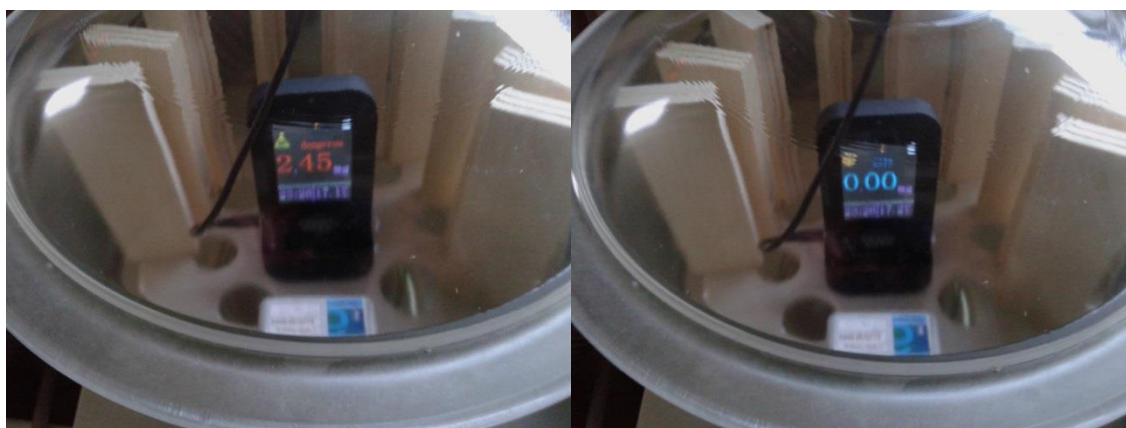
Figura 31 - Experimento com nove corpos de prova de compensado. O detector eletroquímico de formaldeído atinge o valor máximo e zera em seguida.
