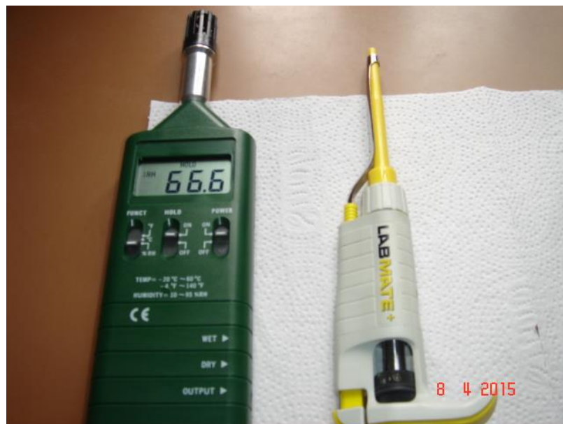
Figura 10 – Termo-higrômetro digital Minipa MTH 1360 e micropipeta LAB MATE com capacidade entre 20 e 200 µl.
