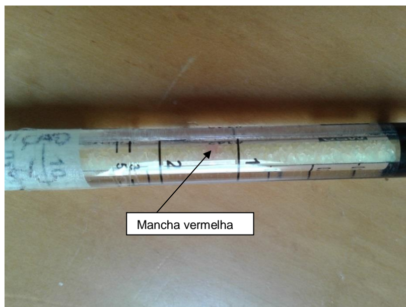
Figura 12 – Anel vermelho no tubo MSA AUER durante medição em laboratório de Anatomia Patológica.
