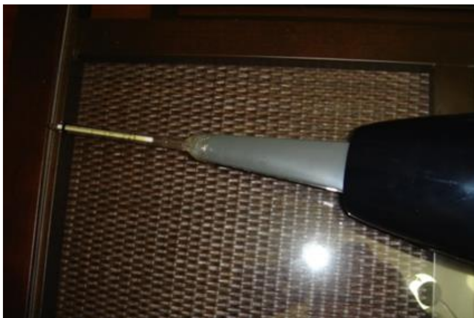
Figura 26 – Tubo colorimétrico com aspirador de pó portátil utilizado como bomba de sucção
