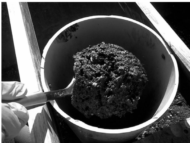
FIGURA 4.6 - COLETA DE ESCUMA COM ESCUMADEIRA PARA DETERMINAÇÃO DO VOLUME GERADO (OUTUBRO, 2012)
