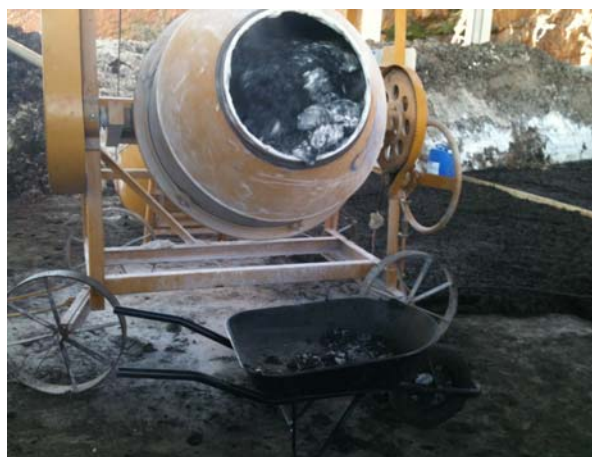
c) carregamento da betoneira com espuma, lodo de esgoto e cal virgem.
