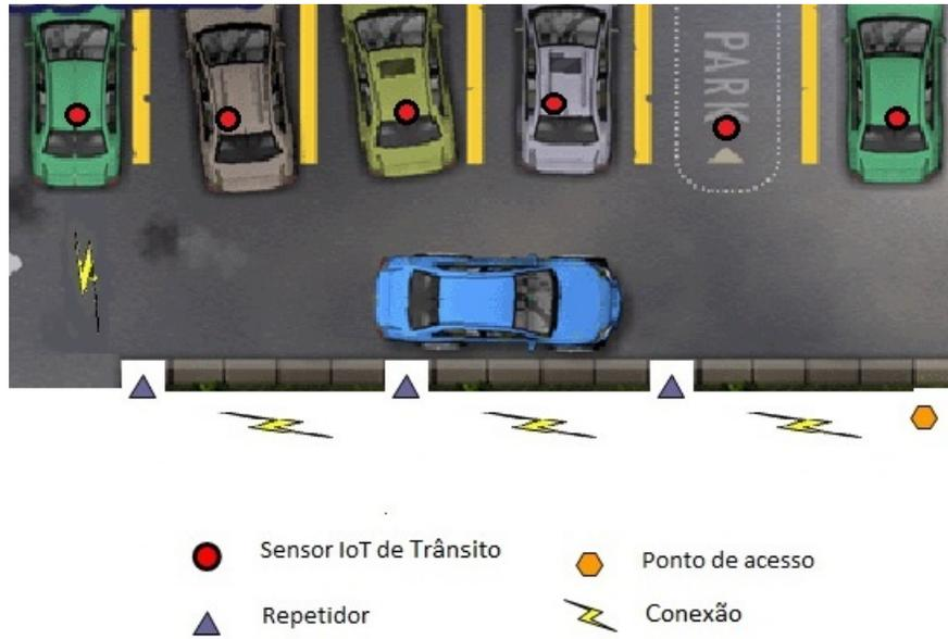
Figura 2.3: Exemplo da arquitetura da aplicação de monitoração de vagas de estacionamento.
