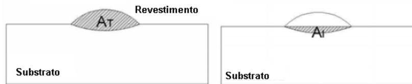
FIGURA 12 – REPRESENTAÇÃO DAS ÁREAS DE CÁLCULO DA DILUIÇÃO.
