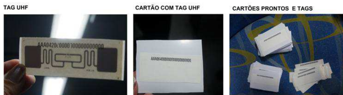
FIGURA 32 - FOTOGRAFIAS DA TAG E CARTÕES COM TAGS UTILIZADOS NO TESTE FONTE: o autor (2015).
