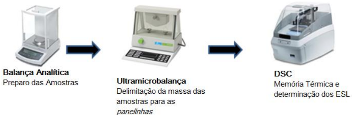
FIGURA 4 - PROCEDIMENTO PARA DETERMINAÇÃO DAS CURVAS DE EQUILÍBRIO SÓLIDO-LÍQUIDO E PONTO DE NÉVOA FONTE: A autora (2015)
