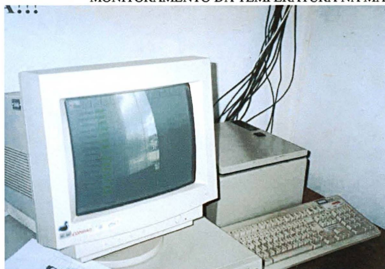
FIGURA 15 – CABOS DE COMPENSAÇÃO LIGADOS AO COMPUTADOR/SENSORES PARA MONITORAMENTO DA TEMPERATURA NA MASSA DE LODO
